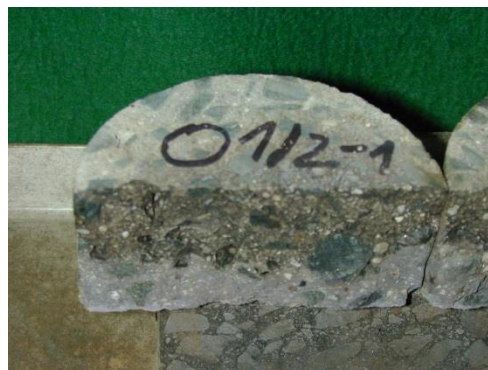
Obrázek 2.: Schéma zařízení NORDTEST Obrázek 3.: Vzorek po aplikaci \text{AgNO}_3
