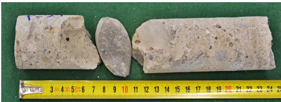
Obrázek 4.: Jádrový vývrt P-S1 o průměru 50 mm, při odběru se rozpadl vlivem velkého zrna kameniva a jeho nízké soudržnosti s tmelem.
