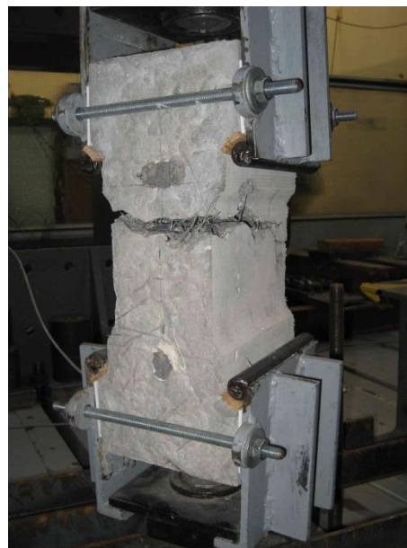
Obrázek 5.: Zkušební těleso na konci zkoušky
