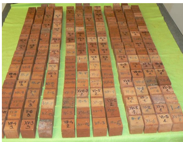
Obrázek.: 10 Zkušební tělesa - krychle o hraně 50 mm pro stanovení pevnosti v tlaku
