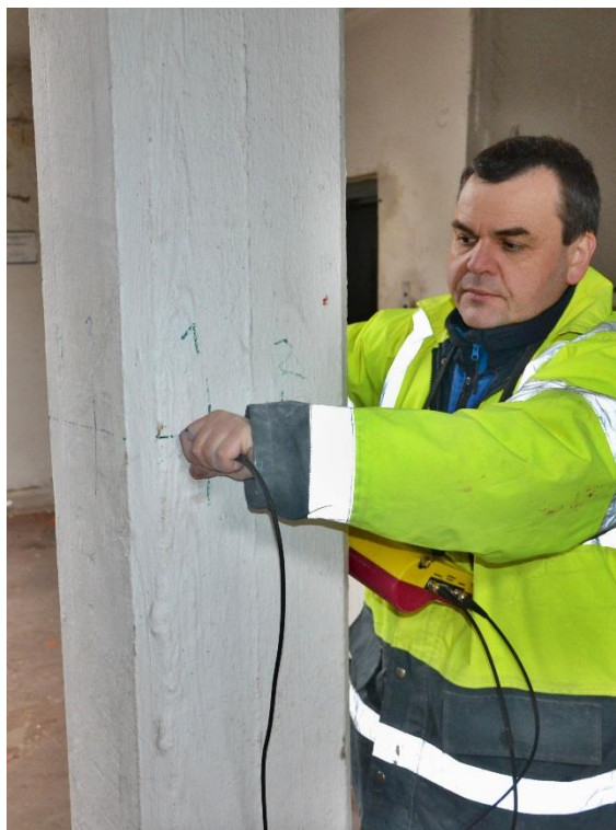
Obrázek 3.: Stanovení rychlosti šíření impulzů ultrazvukového vlnění přístrojem TICO.
