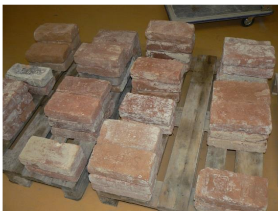
Obrázek 3.: Cihly odebrané z konstrukce byly očištěny a tříděny dle vnějších znaků
