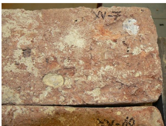
Obrázek 5.: Cihly obsahovaly díky technologii výroby řadu vad, zde masivní cicváry
