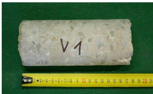
Obrázek 8.: Vzorek V 1 betonu nosné konstrukce. Vývrt o průměru 75 mm.
