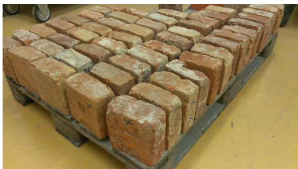
Obrázek.: 9 Poloviny cihel připravené ke stanovení pevnosti v tlaku
