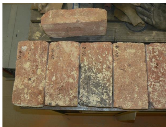
Obrázek 4.: Cihly z jedné sady se často lišily rozměry i barvou střepe
