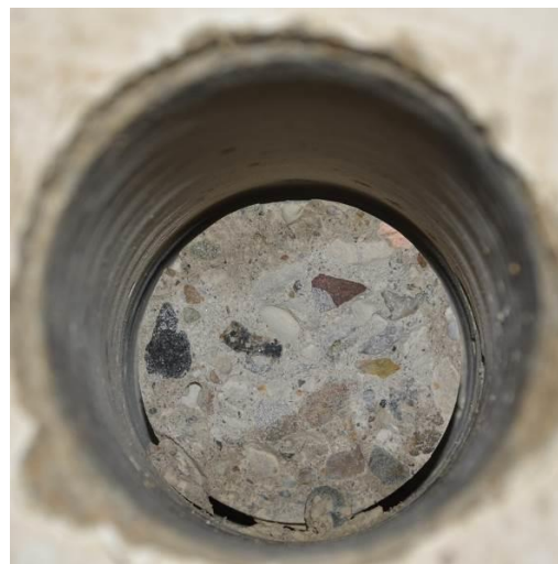
Obrázek 7: Struktura betonu ve vývrtu V 1.
